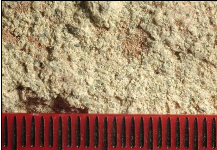
Figura 40 - Macrofotografia, Luce Artificiale (1 tacca del righello equivale a 1 mm). Il lato inferiore del campione mostra l'intonaco di colore chiaro, in cui si scorgono dei granuli grigio chiaro riferibili all'aggregato. In alcuni punti è presente una colorazione rossiccia riferibile a polvere di mattone della muratura sottostante.
