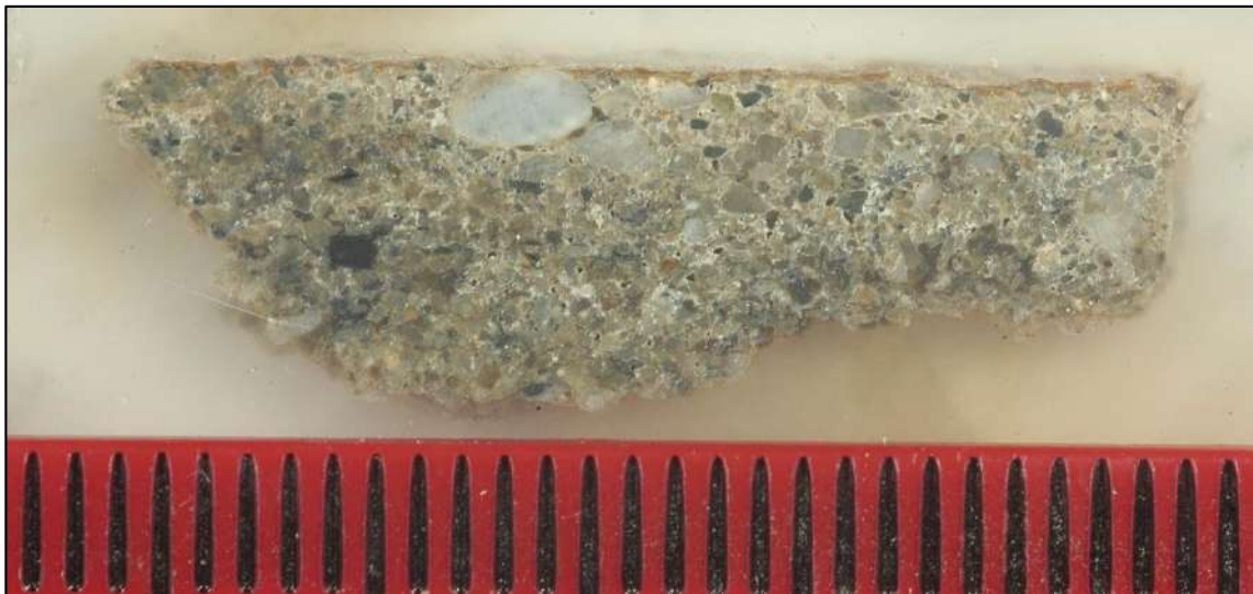
Figura 41 - Sezione Lucida, Luce artificiale (1 tacca del righello equivale ad 1 mm). Visione di insieme della Sezione Si può osservare l'intonaco, con un granuli dai bordi arrotondati e colore chiaro di dimensioni millimetriche posto a immediato contatto del livello pittorico costituito da un livello ocre ben evidente su cui compare un esile livello beige
