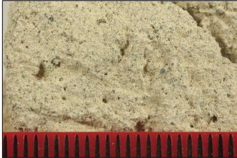
Figura 9 – Macrofotografia, Luce Artificiale (1 tacca del righello equivale a 1 mm). La parte posteriore del campione mostra l'intonaco di colore beige a grana fine.
