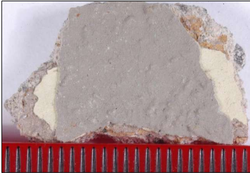
Figura 24 - Macrofotografia, Luce Artificiale (1 tacca del righello equivale a 1 mm). Il frammento prelevato mostra, sotto al colore attuale, la presenza di vari livelli colorati, tra cui spiccano lo strato crema e quello più in basso di colore rosso mattone.
