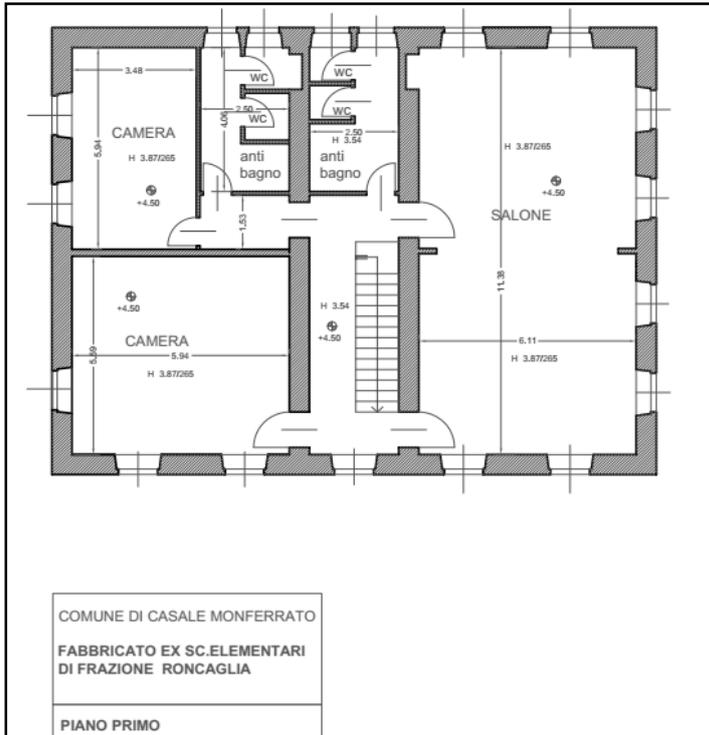
Il fabbricato è costituito da strutture verticali in muratura intonacata portante e orizzontamenti in muratura a volte a vela per i locali principali e volte a botte nel vano scala centrale.
